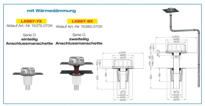
**Begleitheizung:** Wir empfehlen, nach Prüfung Dachabläufe und Leitungen in frostgefährdeten Bereichen gegebenfalls mit einer bauseitigen Begleitheizung zu versehen.
